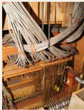
Innenansicht des Spieltischs Die Überarbeitung sämtlicher Teile war besonders aufwendig, wozu der Spieltisch komplett zerlegt werden musste.
