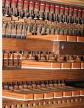
Konsequente Überarbeitung des pneumatischen Spieltischs Alle Koppelbälgchen wurden mit neuem Spaltleder bezogen.
