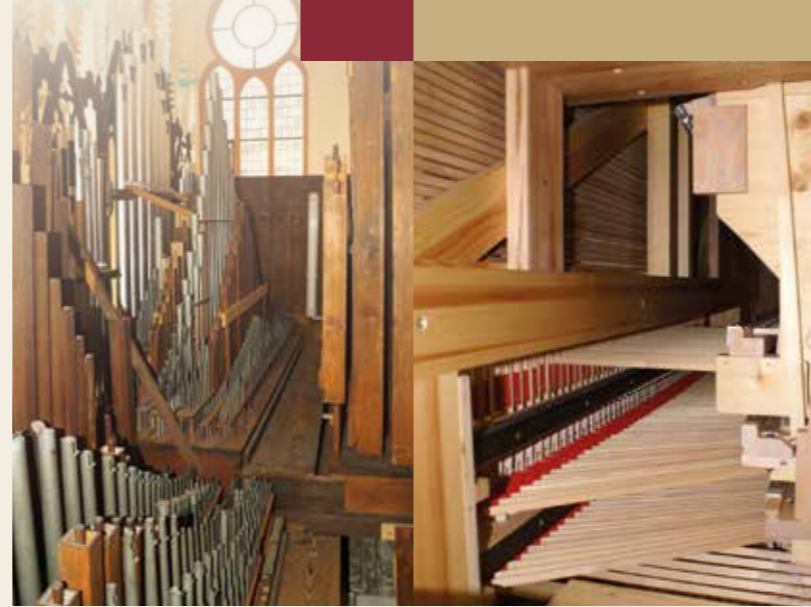
Waagrecht und teilweise strahlenförmig verlaufende Tontrakturen vom Spieltisch, bis zu den jeweiligen Winkelbalken der Werke.
